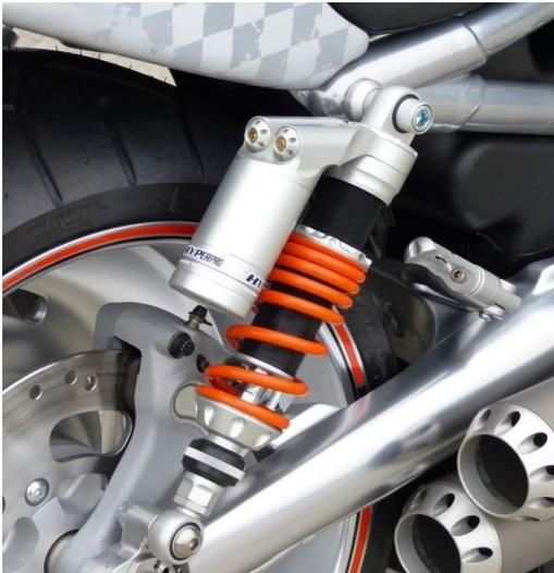
Längenverstellung der Dämpfer mit angeboten werden. Durch verschraubte Stoßdämpferaugen lässt sich die Dämpferlänge in einem Bereich von + / - 5mm (10mm) verstellen.
