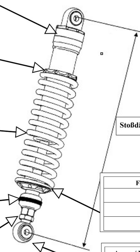
Stoßdämpfer Länge  mm    Optional – Zusätzliche Längen- / Höhenverstellung (Aufpreis) ±5mm
