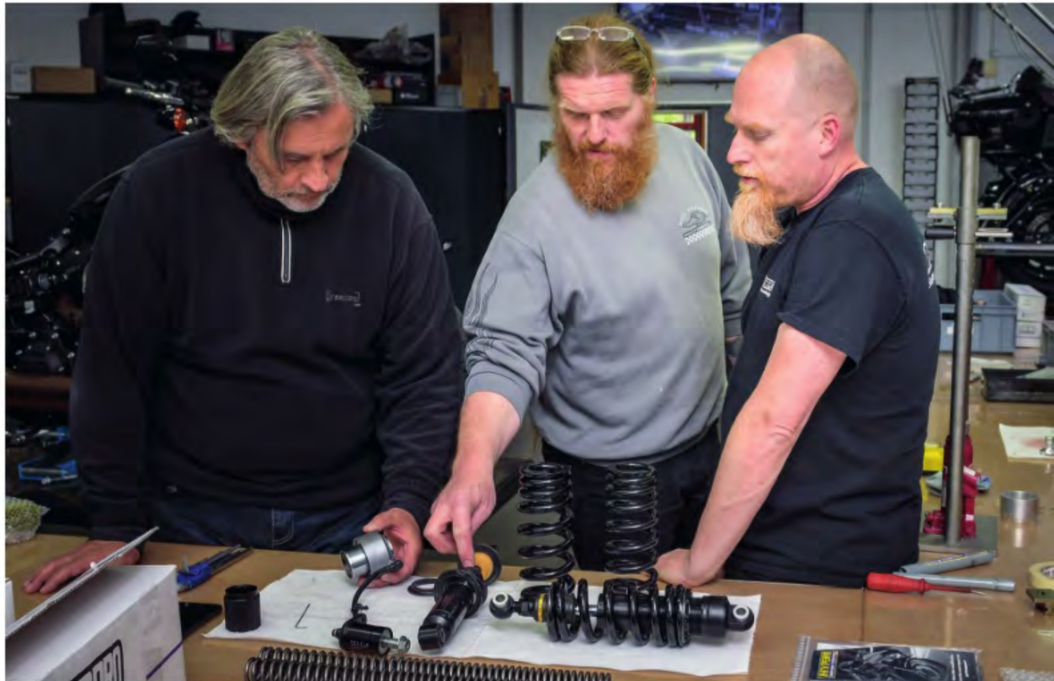
Oben: Peter beim Ausbau des originalen Federbeins. Das kommt dann in die Federpresse, die originale Feder wird durch eine Hyperpro-Feder ersetzt
