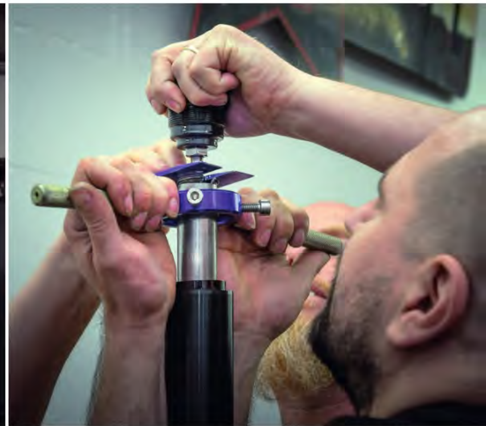
R&R-Mann Andi beim Ausbau der Gabelbeine, die danach mit Hilfe von Spezialwerkzeug zerlegt werden. Das alte Gabelöl kommt raus und wird anschließend durch Gabelöl von Hyperpro ersetzt
