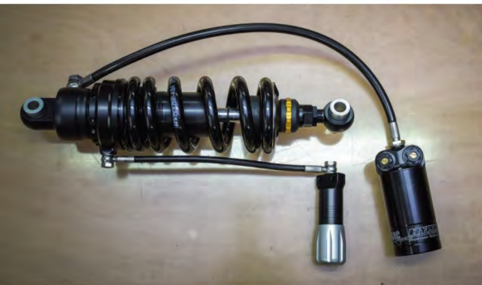
Das Full-Option-Federbein in seiner ganzen Pracht. An dem silbernen Knebel lässt sich die Vorspannung hydraulisch regeln
