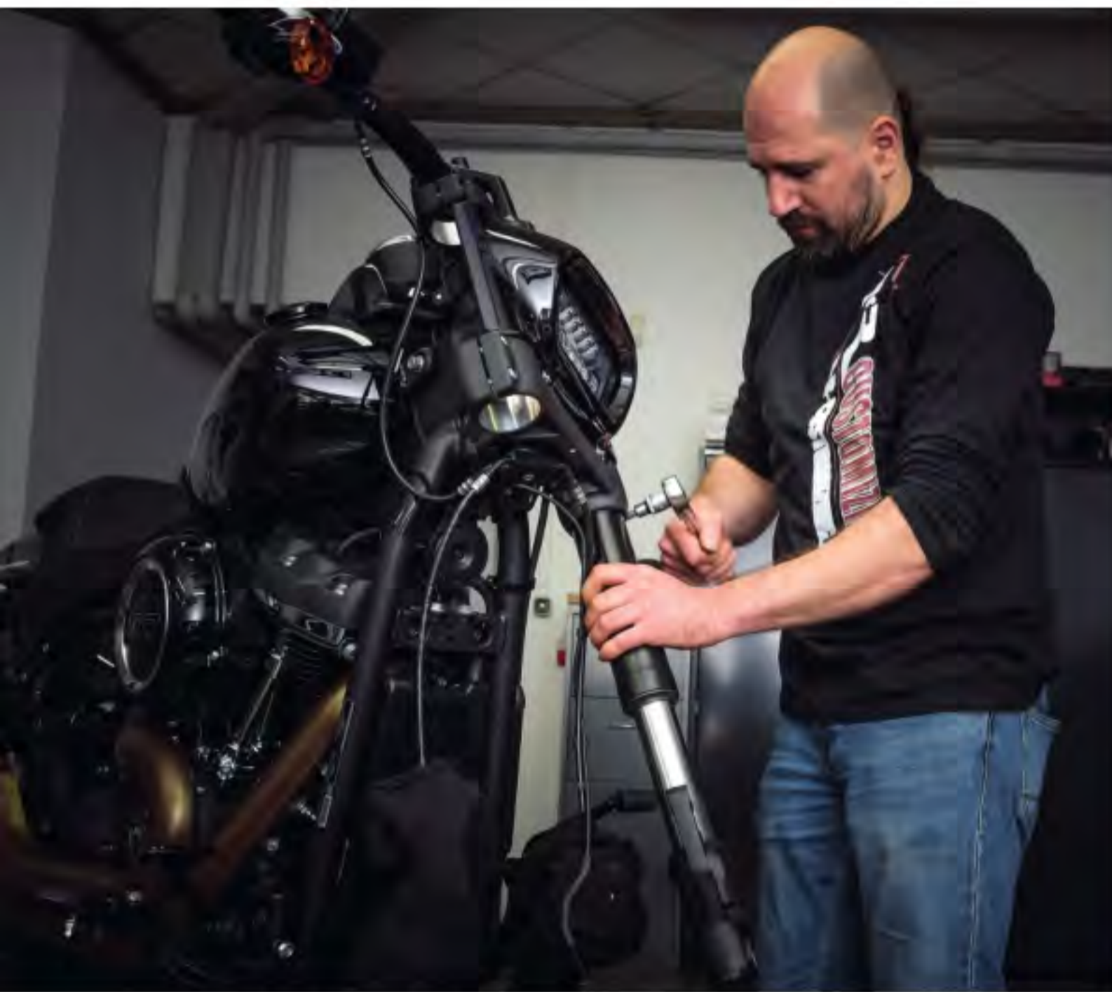
R&R-Mann Andi beim Ausbau der Gabelbeine, die danach mit Hilfe von Spezialwerkzeug zerlegt werden. Das alte Gabelöl kommt raus und wird anschließend durch Gabelöl von Hyperpro ersetzt
