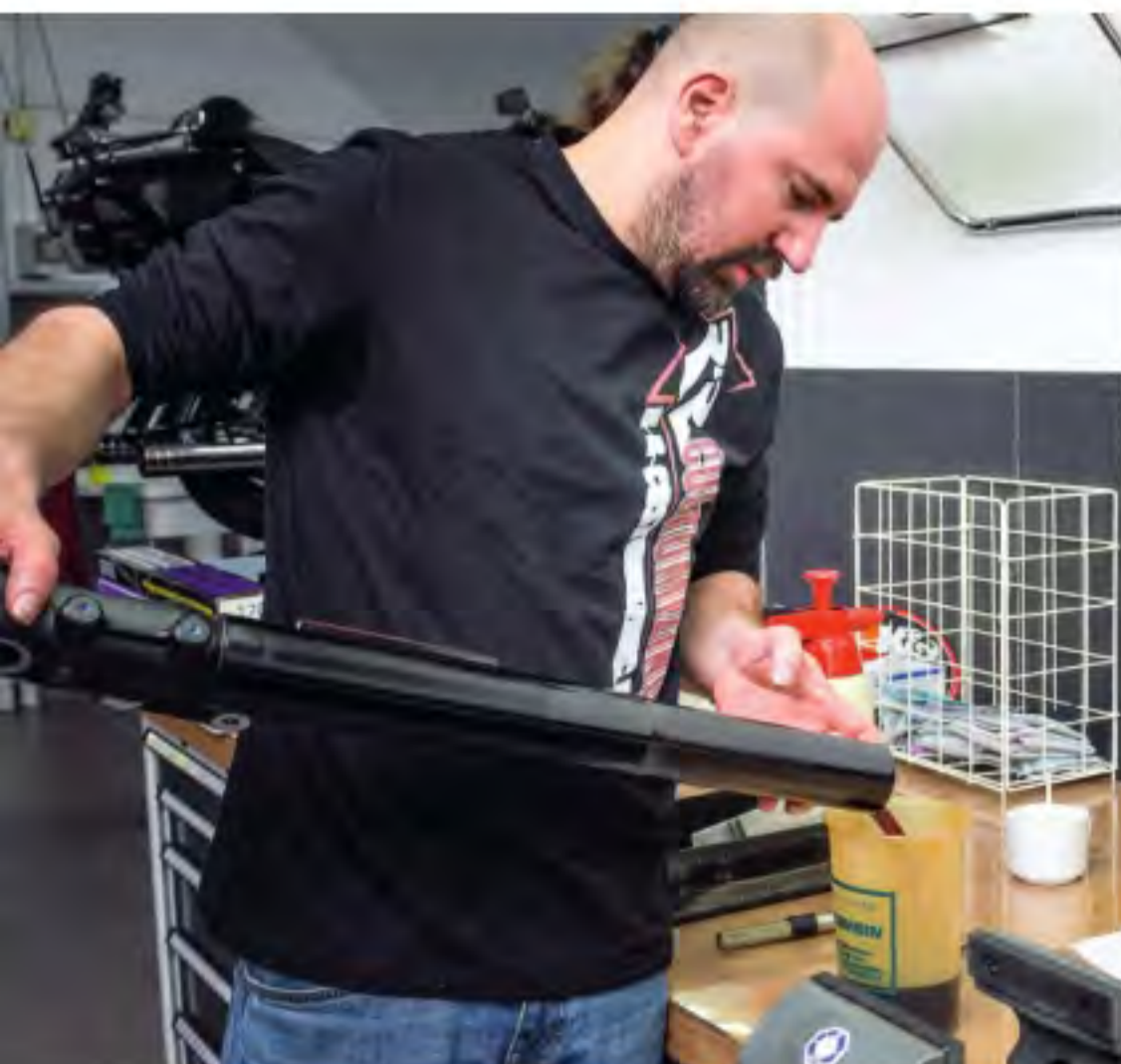
R&R-Mann Andi beim Ausbau der Gabelbeine, die danach mit Hilfe von Spezialwerkzeug zerlegt werden. Das alte Gabelöl kommt raus und wird anschließend durch Gabelöl von Hyperpro ersetzt
