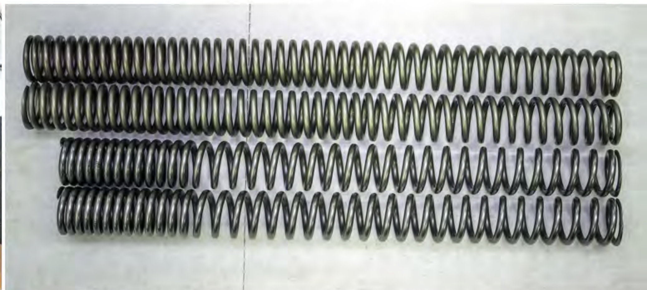
Das untere Federpärchen ist das von Hyperpro. Es fällt auf, dass es kürzer ist als die originalen Federn. Dennoch wird die fehlende Strecke nicht mit einer Büchse ausgeglichen
