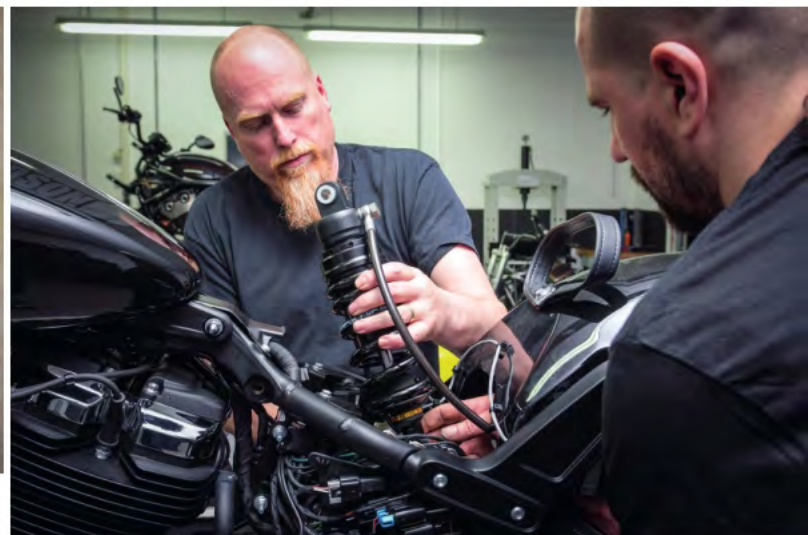
Das Full-Option-Federbein in seiner ganzen Pracht. An dem silbernen Knebel lässt sich die Vorspannung hydraulisch regeln
