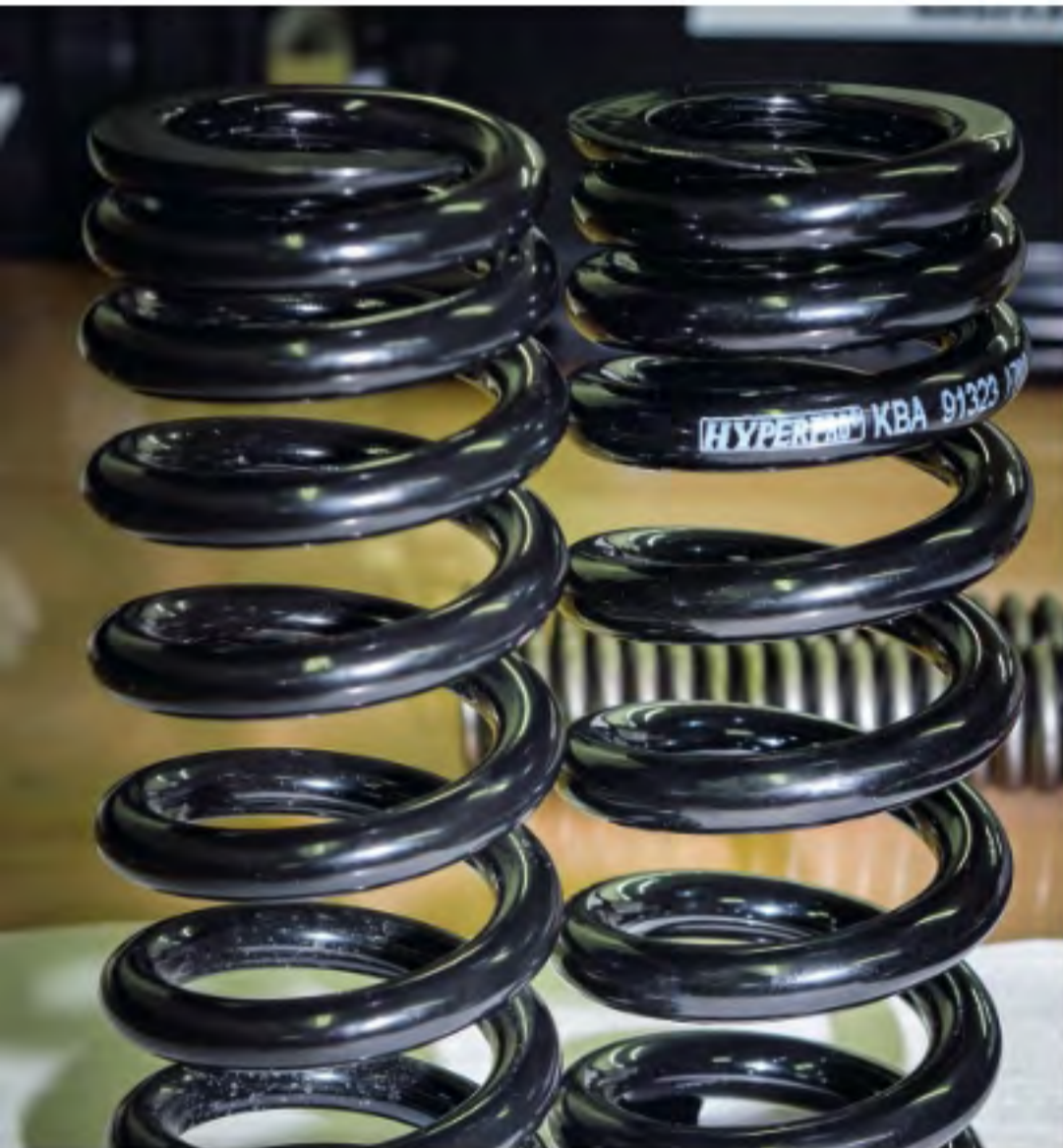
Die Hyperpro-Feder ist ein wenig kürzer und hat an ihren beiden Enden deutlich mehr plane Auflagefläche
